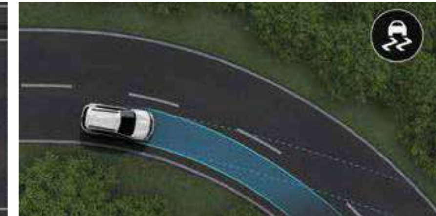
ESP Es un sistema de control electrónico que le permite corregir la trayectoria de un automóvil para evitar que se salga de la carretera. Conduce con seguridad, en todo momento.
