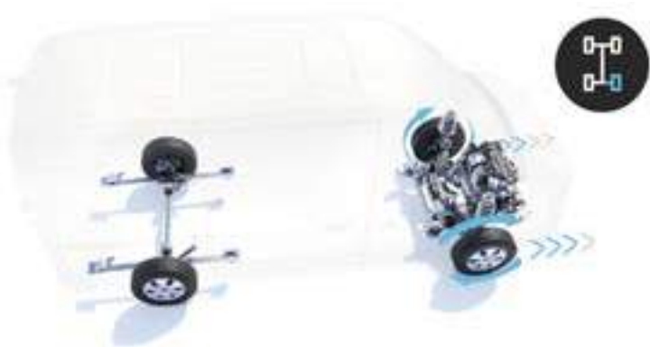
ASR El control electrónico de tracción (ASR) reduce la potencia del motor y actúa sobre los frenos cuando alguna de las llantas se resbala para evitar que gire en vacío.
