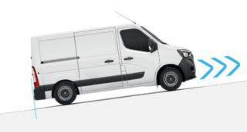
asistente de arranque en pendiente (HSA) asistente de arranque en pendiente (HSA). La asistencia de arranque en pendiente mantiene la presión de frenos automáticamente durante 2 segundos para darle tiempo a levantar el pie del pedal de freno y presionar el acelerador. El sistema se activa cuando la pendiente es superior al 3%.
